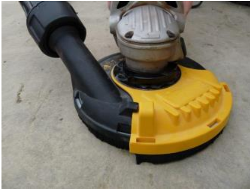
Figuur 3 Slijpmachine met afzuiging (Bron HSE, GB)
