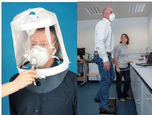
Figuur 6 Kwalitatieve en kwantitatieve face-fittest (Bron HSE, GB)
