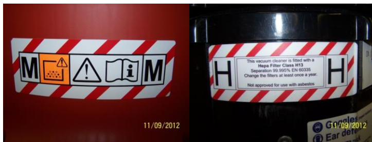
Figuur 4 Label op afzuigunits van M-klasse of H-klasse (Bron HSE, GB)
