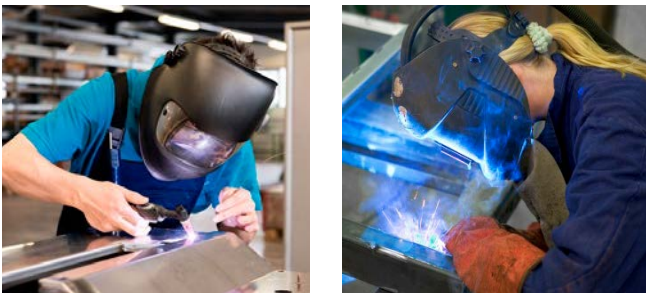
Figuur 1: Links: Verbeterde laskap, sluit aan op de borst Rechts: laskap met slabbe
