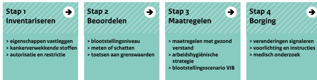
Figuur 1: De vier stappen van het model dat de Inspectie SZW gebruikt voor en aanreikt aan bedrijven die te maken hebben met gevaarlijke stoffen. Bron: https://www.zelfinspectie.nl/zelfinspecties/werken-met-gevaarlijke-stoffen
