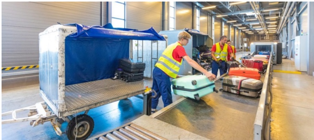
Afb 3.2: Leegmaken van karren op een transportband (type 'single lateral')
