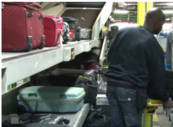
Afb 3.5: Beladen van een ULD vanaf een dubbele lateral
